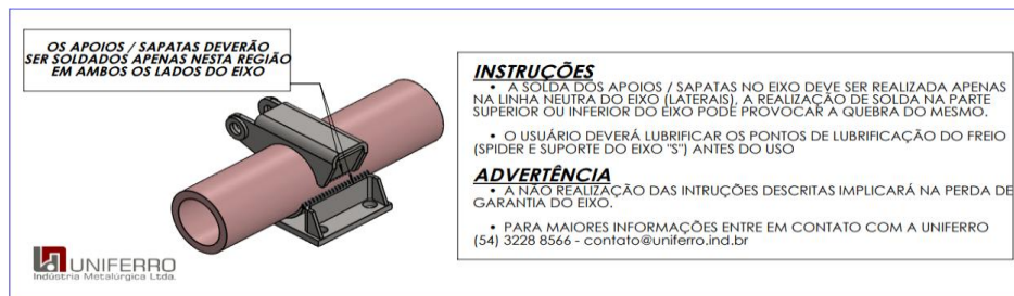
FIGURA 6: ETIQUETA INSTRUÇÃO DE SOLDA.
